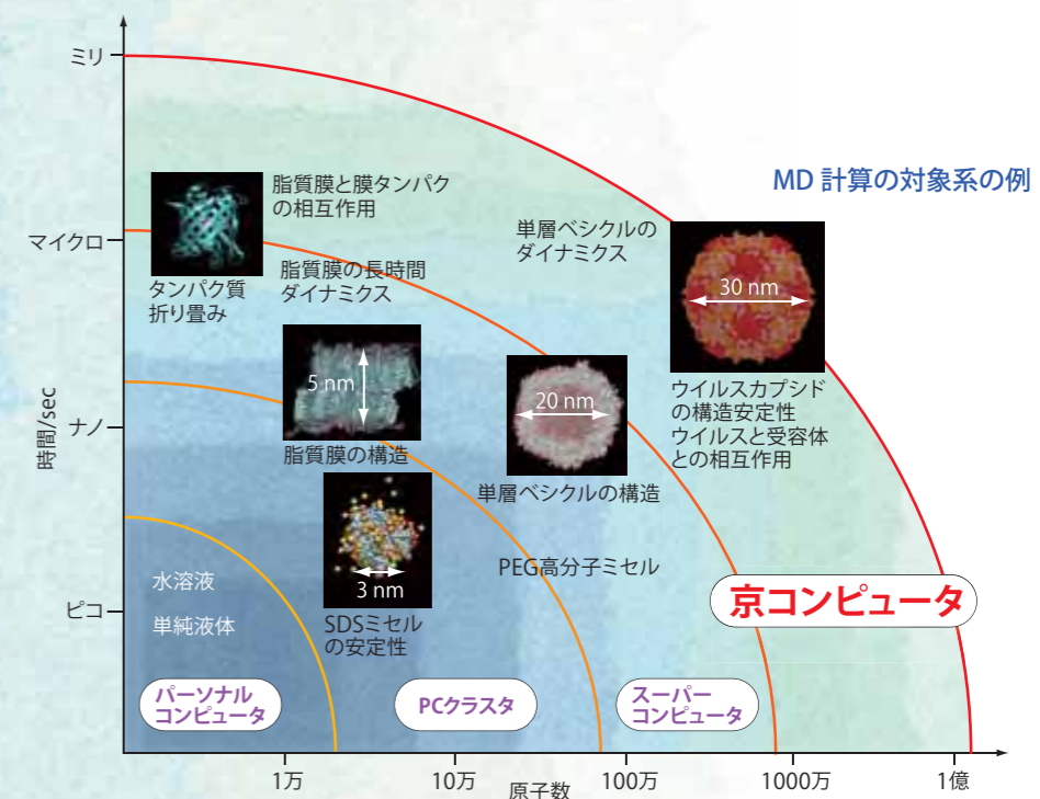
図1. 分子動力学計算(MD)法が対象とする系の大きさとその時間スケール コンピュータとアルゴリズムの進歩に伴って、計算規模が広がってきた。最初のMDが試みられたのは1957年、わずか100原子規模。
